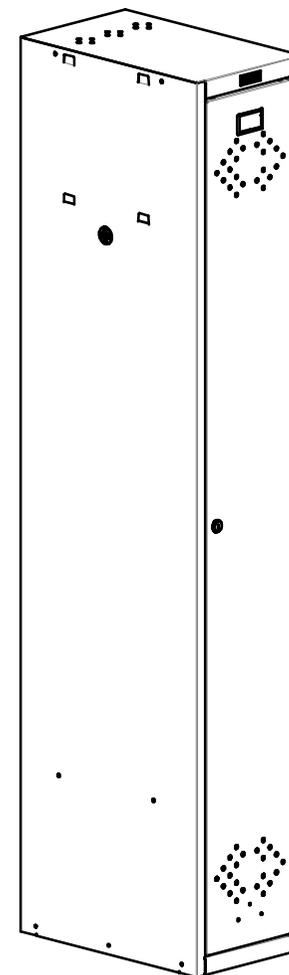
Конструкция шкафа предусматривает сборку или на саморезах, или на заклепках. В случае сбора на заклепках, они устанавливаются вместо саморезов, а также дополнительно в местах, указанных на рисунках.
